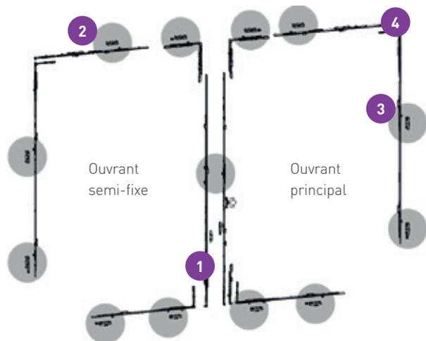
Oscillo-battant avec ferrage symétrique, retardataire d'effraction de série grâce à ses multiples points de verrouillage (sécurité type RC2)
